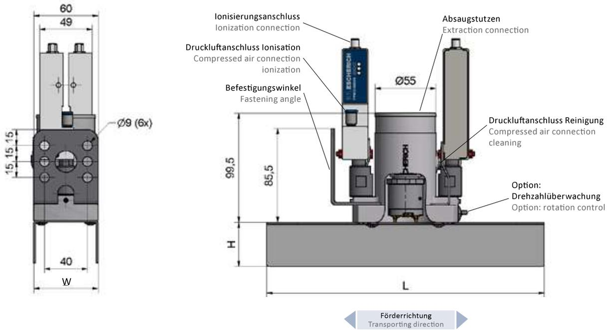
Beidseitige Förderrichtung gilt nur für TC010ESD-02-03-D61, sonst Einlaufrichtung am Ionisator.
