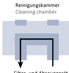
Partikelhaltige Luft zum Absauggerät
